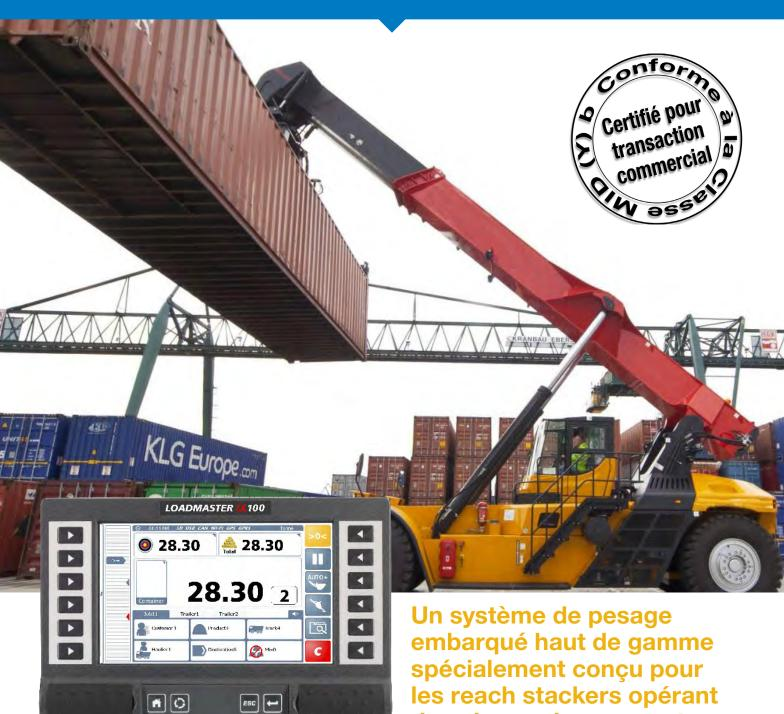
Le **LOADMASTER C**100 est un système BUS-CAN apportant une réelle avancée pour les utilisateurs. Certifié maintenant pour transaction commerciale, il associe une technologie de pointe de plusieurs capteurs et un logiciel de calcul évolué, afin de donner les informations précises du poids du produit.
