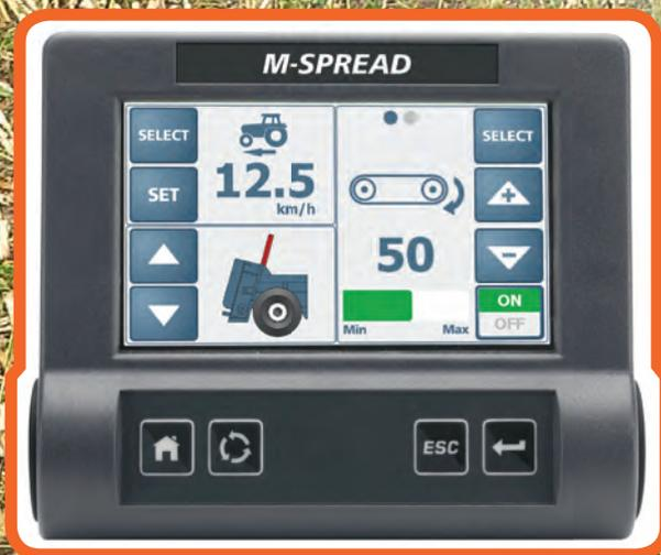
Le M-SPREAD est un système DPAE permettant également la commande des fonctions électro-hydrauliques de l'épandeur.
