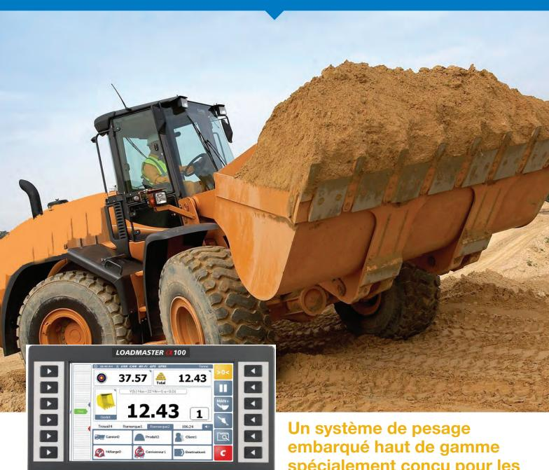
Le **LOADMASTER X100** est un système BUS-CAN établissant une réelle avancée pour les utilisateurs. Certifié maintenant pour transaction commerciale, il associe une technologie de pointe de plusieurs capteurs et un logiciel de calcul évolué, afin de donner les informations précises du poids du produit.
