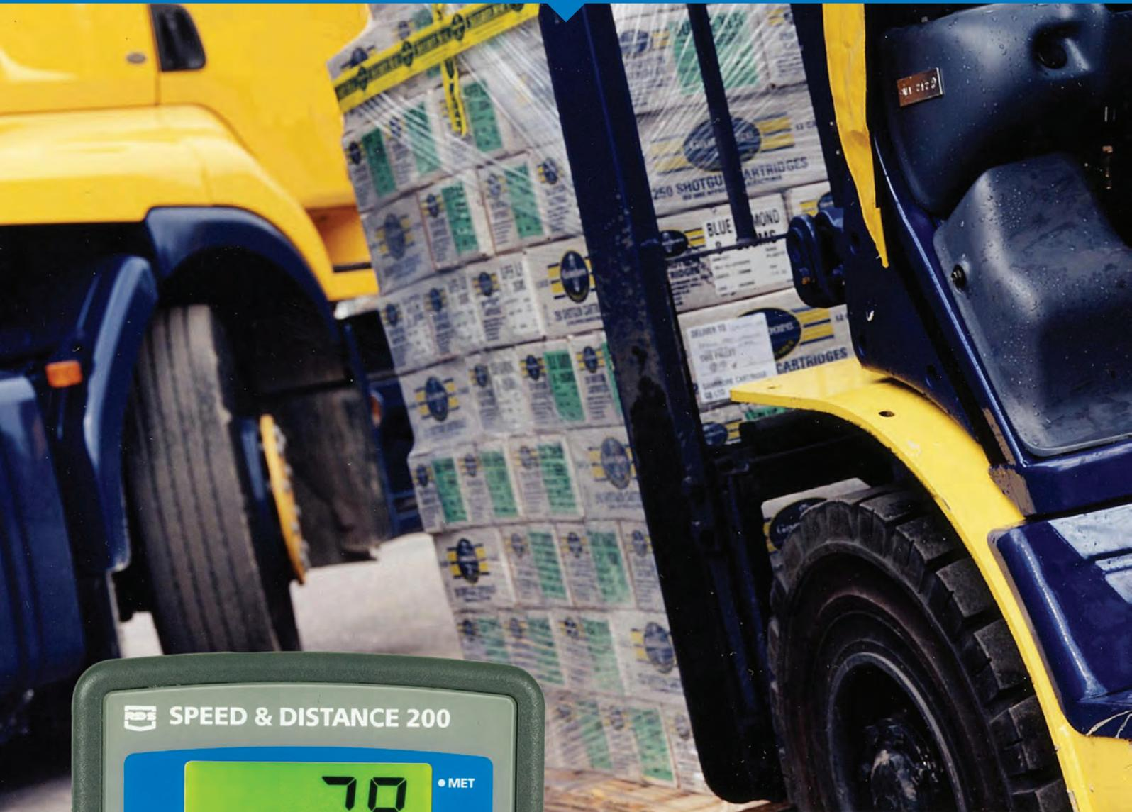
**Un moniteur de vitesse et distance embarqué avec alarme de sur-vitesse**
