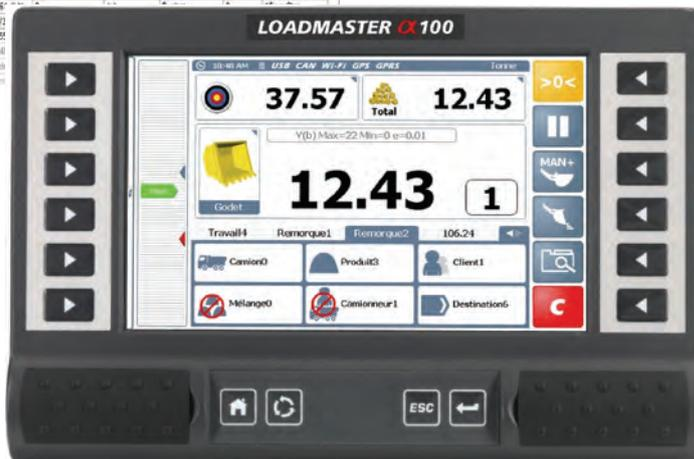
Le logiciel iSOSYNC peut s'utiliser soit avec LOADMASTER α100 soit avec LOADEX 100 et permet le transfert rapide des informations liées à la tâche depuis l'ordinateur central vers la chargeuse ou à la pelle.
