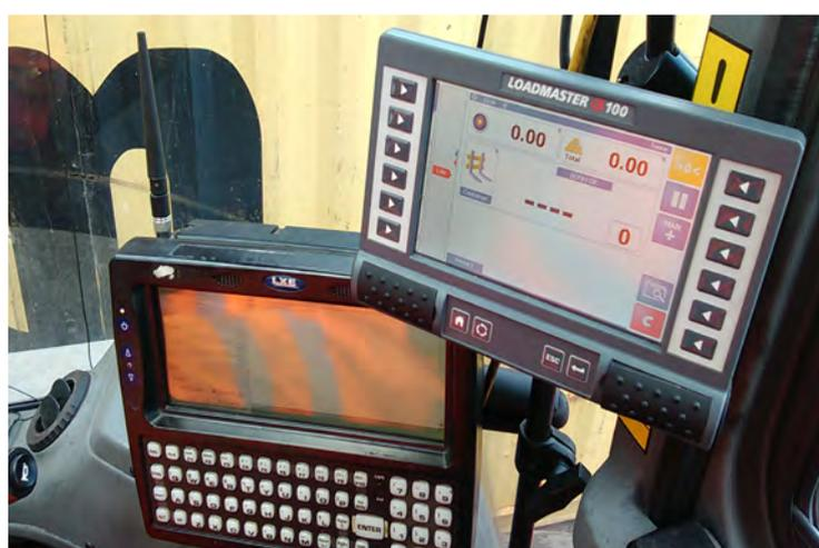
**Un système de pesage embarqué dynamique, spécialement conçu pour les chariots-élevateurs pour répondre aux exigences SOLAS 2016 (Méthode 2)**
